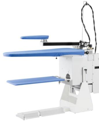
Blas-Saug-Bügeltisch mit Tischblattspitze "links", angebautem Dampferzeuger und Ärmelbügler
