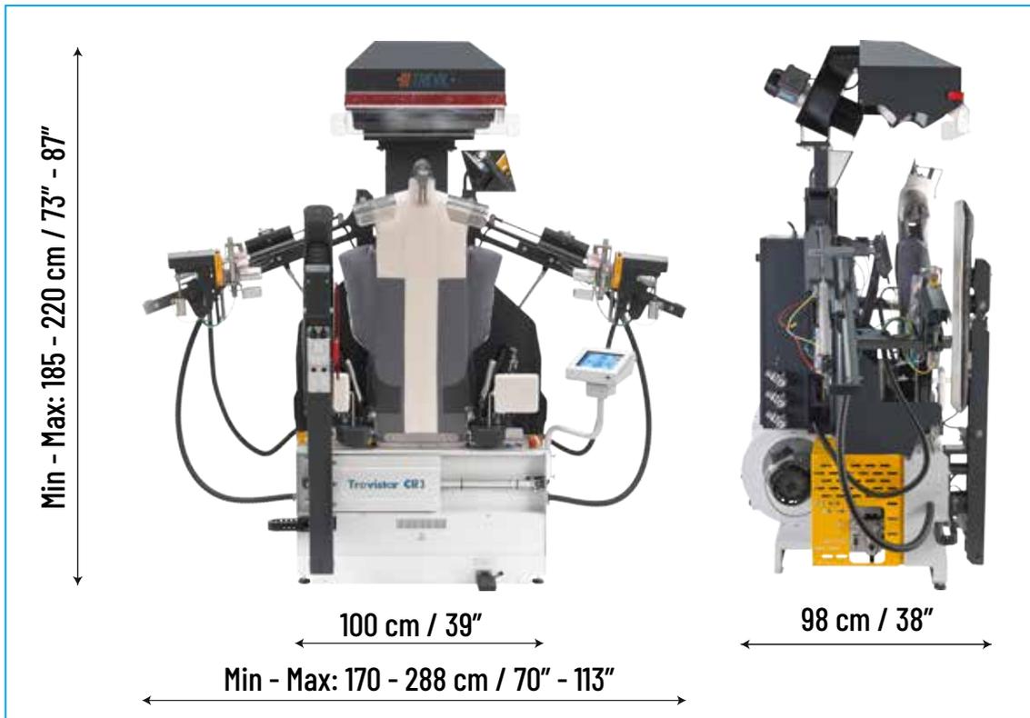
La macchina ha un ingombro a terra di soli 0,8 m<sup>2</sup>. La profondità può essere ridotta a soli 83 cm per l'installazione.
